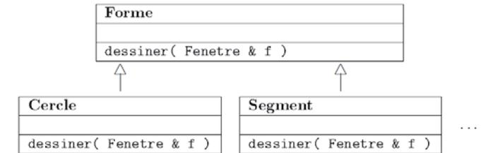
Objectif : On souhaite surcharger la méthode dessiner dans l'ensemble des formes géométrique
